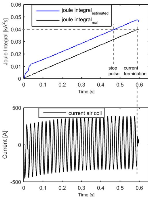
Fig. 10. Exemplary short-circuit test data
