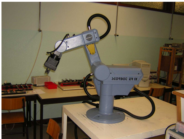
Figura 2 – O braço de robô Scorbot ER-IX residente no Laboratório de Automação e Robótica do DEE-ISEC.
