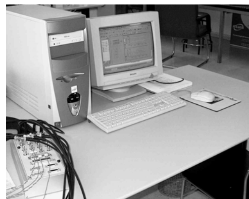
Fig. 6. Tarjeta de control DS1104 y ordenador de monitorización.
